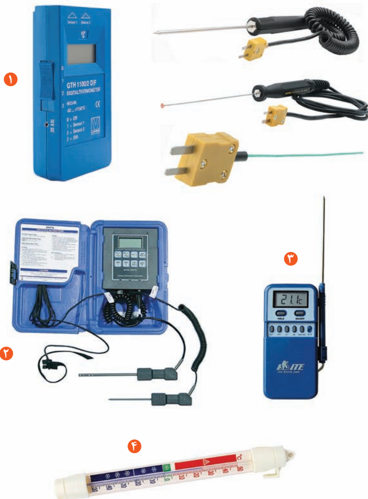
تصویر ۱۱: ترمومتر (دماسنج) الکترونیکی
