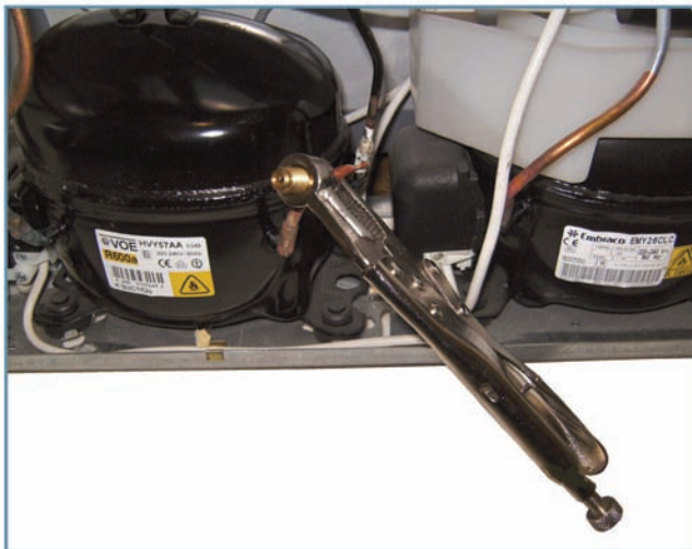
تصویر ۷: قرار دادن انبر قفلی سوراخ‌کن روی لوله‌ی شارژر کمپرسور
