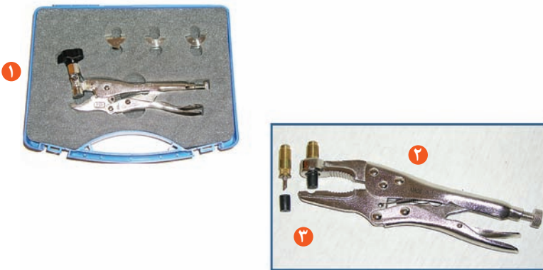
تصویر ۹: انبر قفلی سوراخ کن لوله (انبر دسترسی) قابل تنظیم
