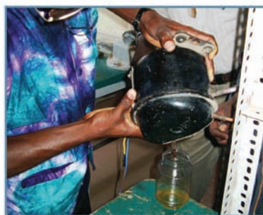
تصویر ۱۷: نمونه‌گیری از روغن درون کمپرسور بسته (هرمتیک)
