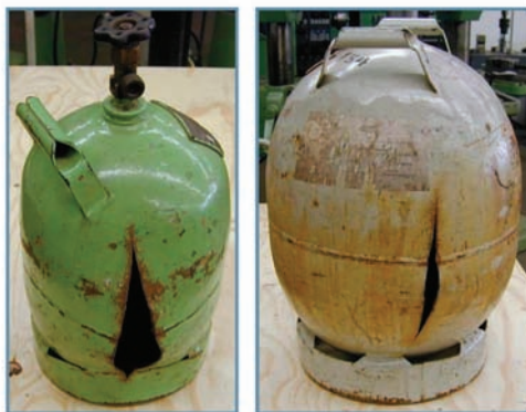
تصویر ۳: نمونه‌هایی از سیلندره‌های منفجر شده
