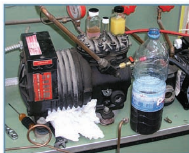
تصویر ۱۸: نمونه‌گیری از روغن درون کمپرسور نیمه‌بسته (نیمه‌هرمتیک)
