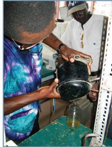
تصویر ۵: تخلیه روغن از یک کمپرسور بسته (هرمتیک)
