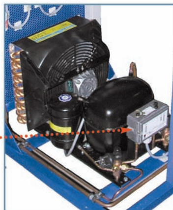
تصویر ۱۷: جزئیات کنترل فشار دوگانه
