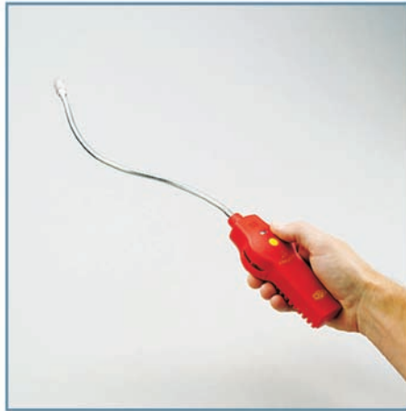
تصویر ۲۱: تست نهایی نشتی با نشت‌یاب الکترونیکی
