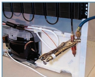
تصویر ۸: انداختن انبر قفلی سوراخ‌کن دیگر روی فیلتر - خشک‌کن
