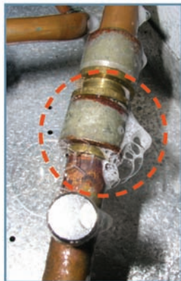
تصویر ۲۳۲: نمونه‌ای از نشستی یک اتصال (به حباب‌ها توجه کنید).
