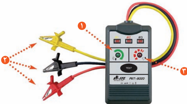
تصویر ۱۳: دستگاه تعیین اتصال صحیح فازها
