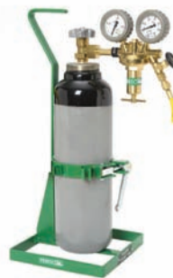
تصویر ۱۷: سیلندر نیتروژن با رگلاتور فشار
