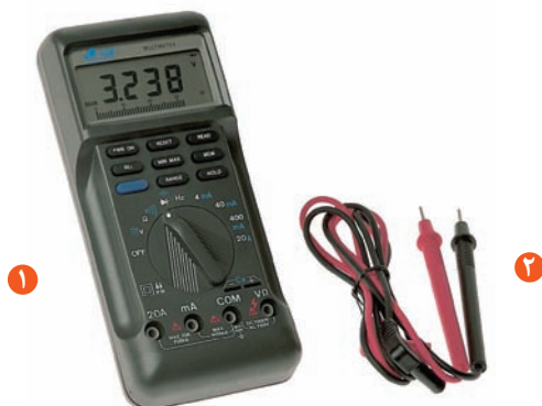
تصویر ۱۴: مولتی‌متر دیجیتال (Auto Range)
