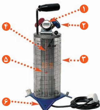
تصویر ۱۰: سیلندر شارژ مبرد واحد متریک
