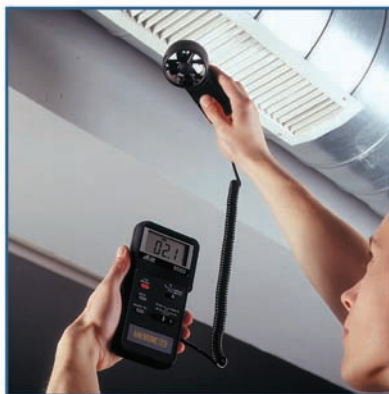
تصویر ۱۵: بادسنج و ترمومتر (دماسنج)
